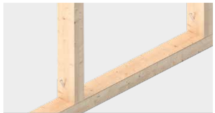
Befestigung von Stützen bei Holz-Rahmenkonstruktionen im Fußschwellenbereich
