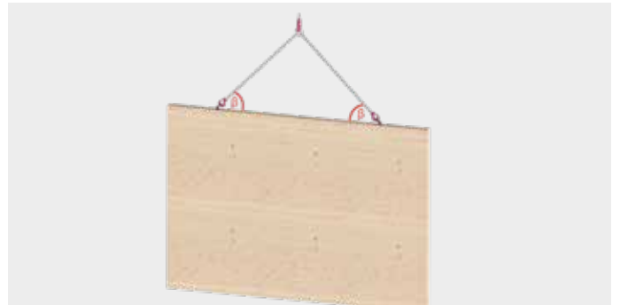
CLT-Wand oder-Träger stehend
