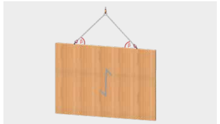
BSH-Wand oder-Träger stehend, Faserverlauf: vertikal
