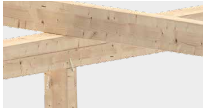
Befestigung von Stützen bei Holz-Rahmenkonstruktionen
