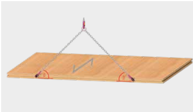
BSH-Wand oder-Träger liegend, Faserverlauf: vertikal
