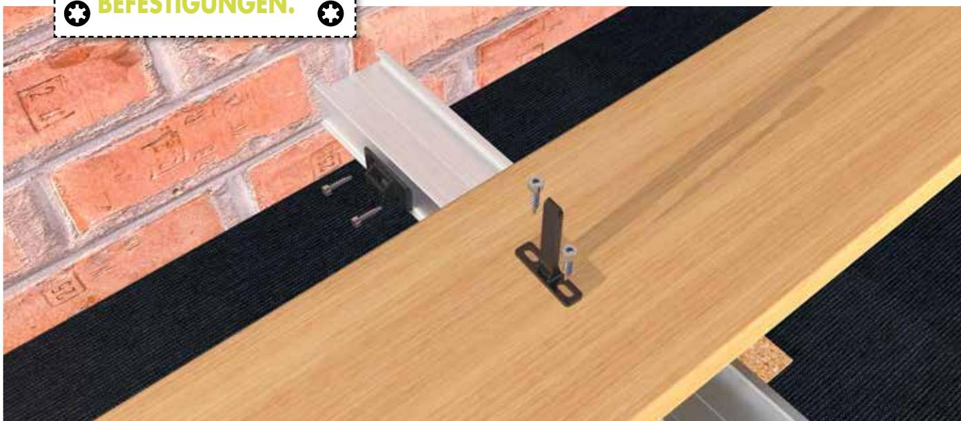
Der Stecker wird unterhalb der Diele befestigt und kann anschließend in die Aufnahme eingerastet werden.
