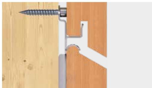
Wandanschluss mit Fassadenclip-Rhombus
