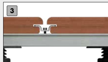
3 Weitere V-Clips einlegen und wieder leicht fixieren, dahinterliegende V-Clips können nun angezogen werden. Achten Sie hier auf die richtige Einstellung des Drehmoments!
