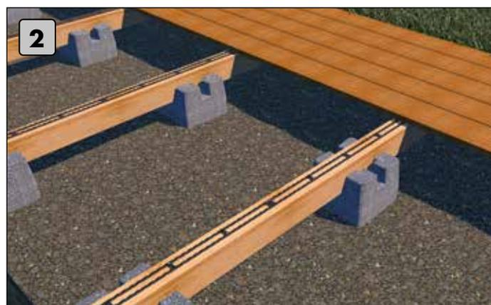
**2 Fundamentsteine aus Beton**
