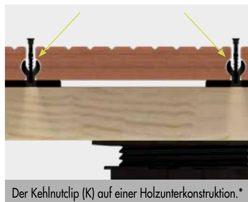
Der Kehlnutclip (K) auf einer Holzunterkonstruktion.\*
