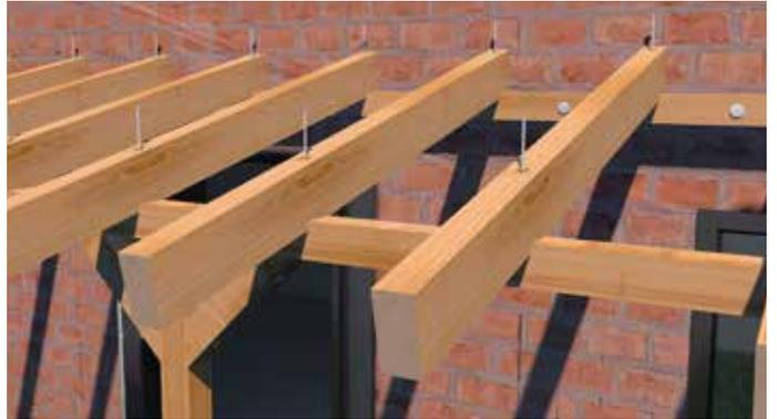
**5** Die Profilhölzer werden, beginnend von unten, zur Hausfassade hin verlegt und mittels **Panelwistec SK** an den Dachträgern angeschraubt.
