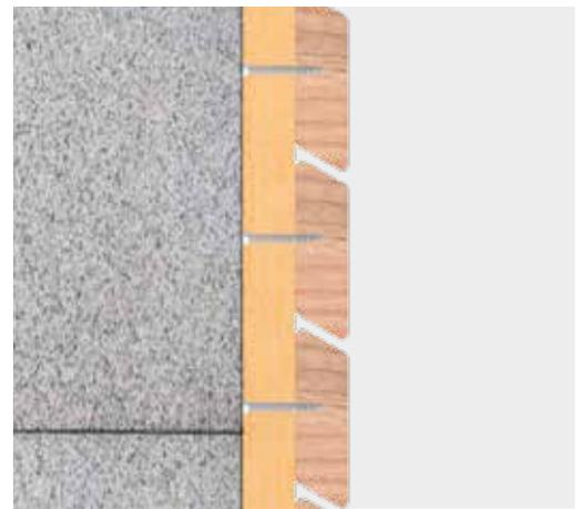
Wandanschluss mit Fassadenschraube ZK
