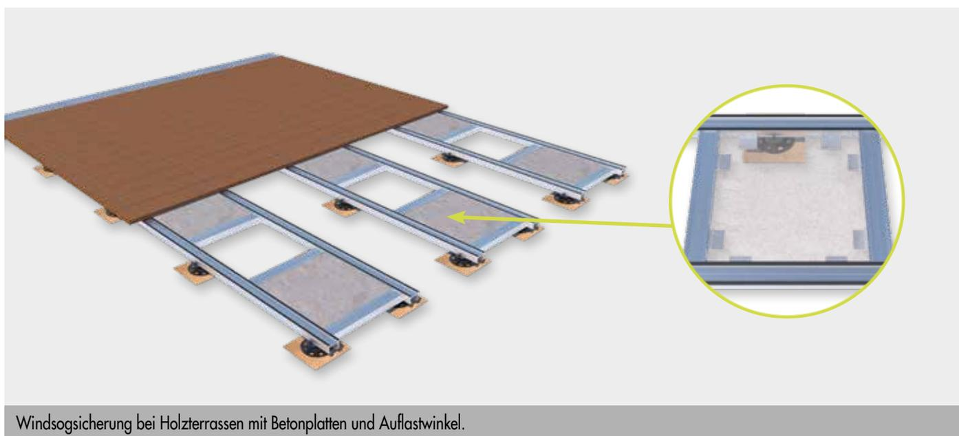
Windsogsicherung bei Holzterrassen mit Betonplatten und Auflastwinkel.
