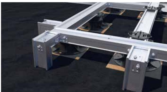
**3** Abschlussprofil unten mit einem 45°-Schnitt über Eck verbinden, mit **BiGHTY-Bohrschrauben** an die Randabschlussprofile schrauben und mit einem **Eckverbinder EVO** sichern.
