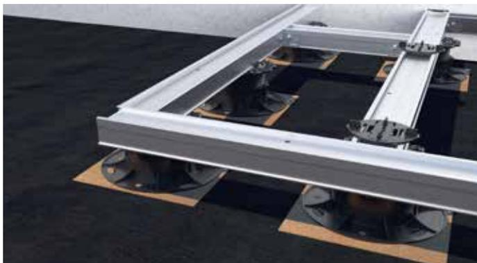
**2** Randabschlussprofile erstellen und an der UK anbringen. Randabschlussprofile bestehen aus: **Alu-Systemprofile EVO**, **Eckverbinder EVO**, **90° Gelenk EVO**, **BiGHTY-Bohrschraube Ø 4,8 x 25 mm** (Art-Nr. 954090-50, VPE 50).
