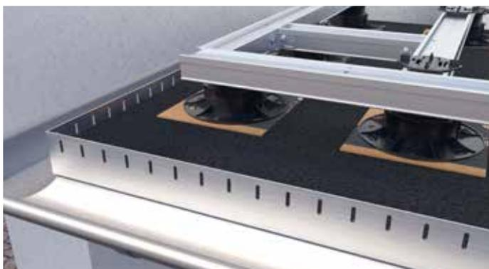
**3** Randabschlussprofile erstellen und an der UK anbringen. Randabschlussprofile bestehen aus: **EVO Profile, Eckverbinder EVO, 90° Gelenk EVO, BiGHTY-Bohrschraube Ø 4,8 x 25 mm (Art-Nr. 954090-50, VPE 50)**
