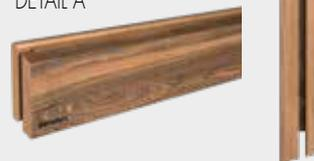
Bei einer senkrechten Verlegung muss bei der Anwendung des Fassadenclips-Rhombus Starter folgendes vorbereitet werden. Wir empfehlen für die Ausbildung einer Tropfkante des Rhombus Profils, eine 15°-Unterschneidung auszuführen. Mit einer 4 mm breiten fachgerechten Einschlitzung des Holzprofils fügen sich der Fassadenclip-Rhombus Starter passgenau an (s. Detail A).
