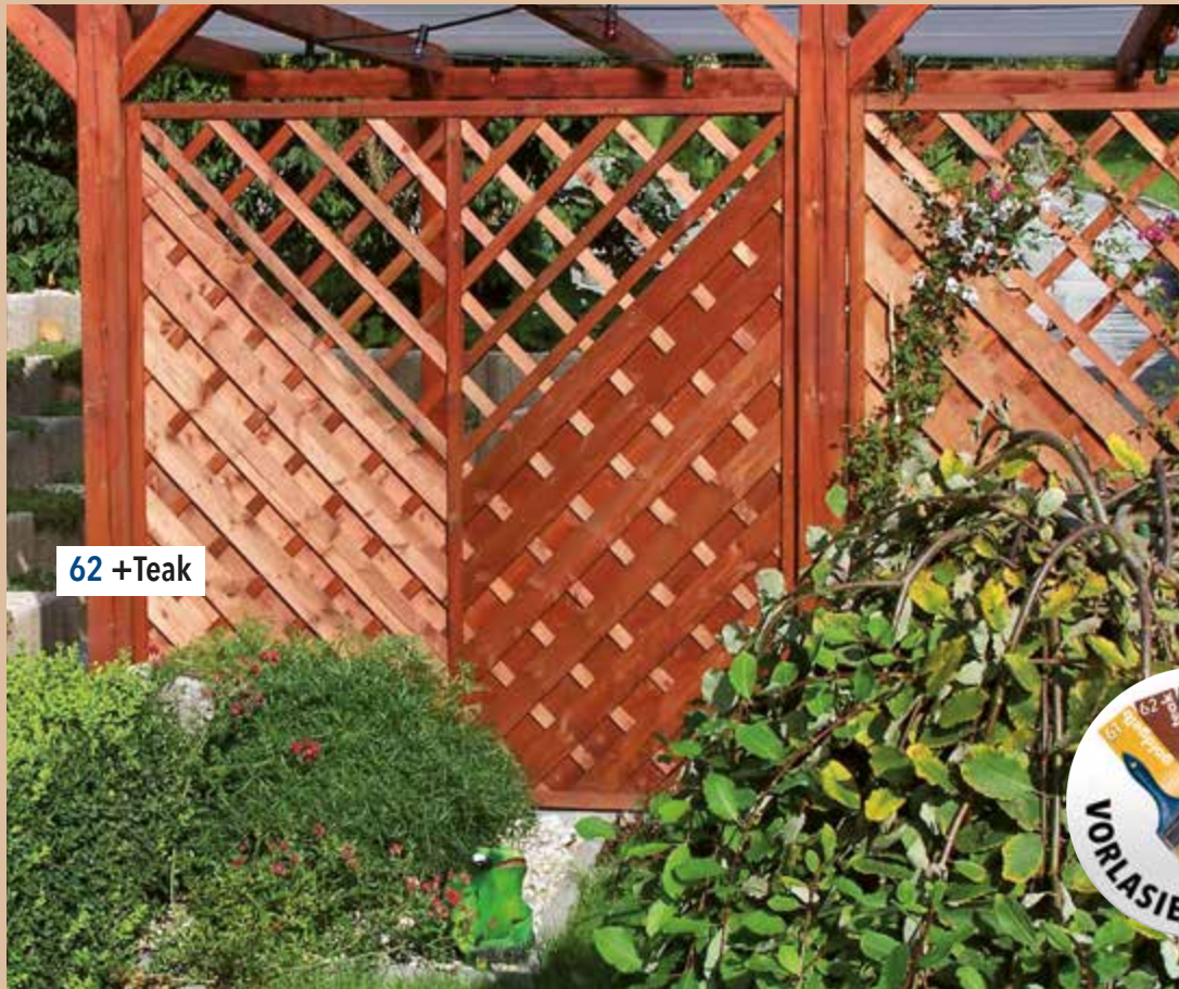
Diagonalzaun Milano Rahmenteile 4,3 x 4,3 cm gehobelt, Lamellen 0,8 x 9,0 cm strukturgehobelt, geschraubt Tür Milano Rahmenteile 4,3 x 9,0 cm gehobelt, Ecken gerundet und gezapft, mit Schlossausfräsung, ohne Beschlag, kesseldruckimprägniert
